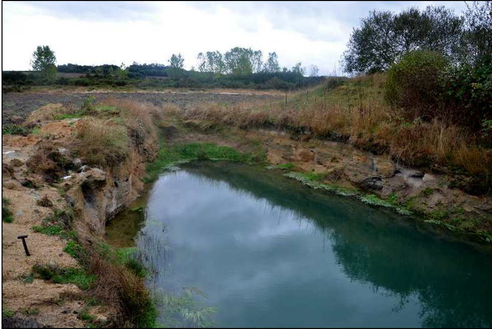
Foto 6.- Aspecto general de la parte sur de la calicata de “ Os Tesos ” en donde aflora el techo de la sucesión cenozoica no lejos de la parcela de estudio. Obsérvese la presencia del nivel freático a solo 1,72 m de la superficie.
